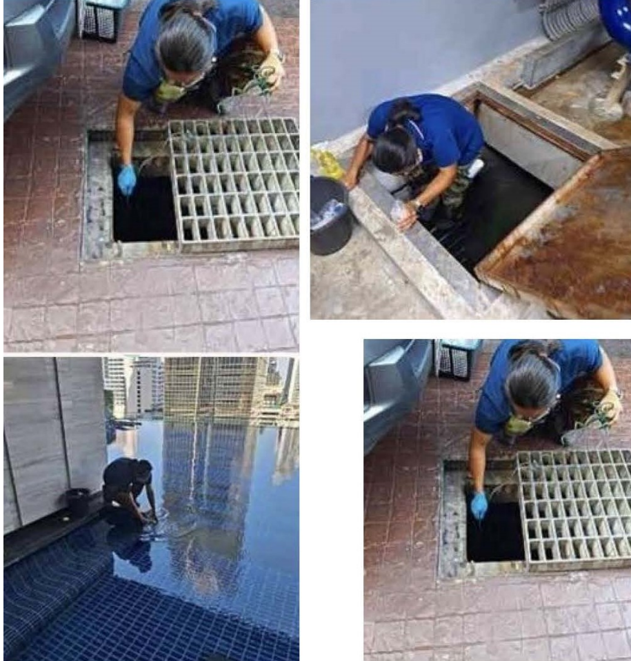
เก็บตัวอย่างน้ำทิ้งที่บ่อตรวจคุณภาพน้ำ และระบายน้ำ และถึงสำรอน้ำได้ดิน
